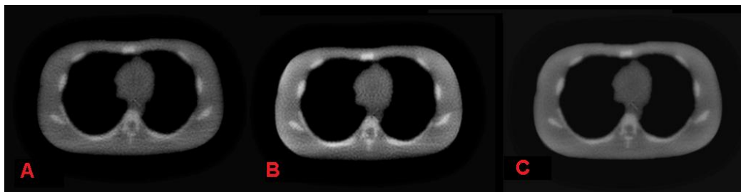
Figura 7. Imagens adquiridas com ângulo de abertura do feixe de 54° (A) 360 vistas e 500 fótons/linha; (B) 360 vistas e 4000 fótons/linha e (C) 720 vistas e 4000 fótons/linha.
